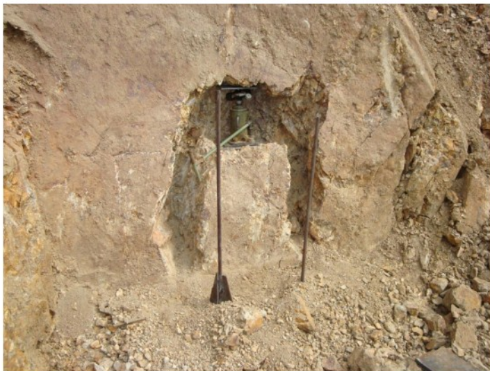
Рис. 3. Определение физико-механических свойств горных пород методом обрушения призмы в натуральных условиях
