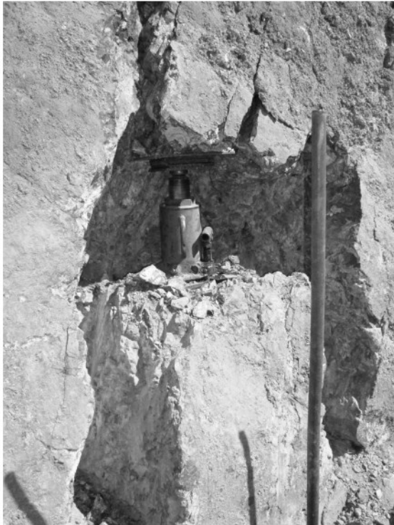
Рис. 6. Разрушение налегающего массива при испытаниях методом разрушения призм
