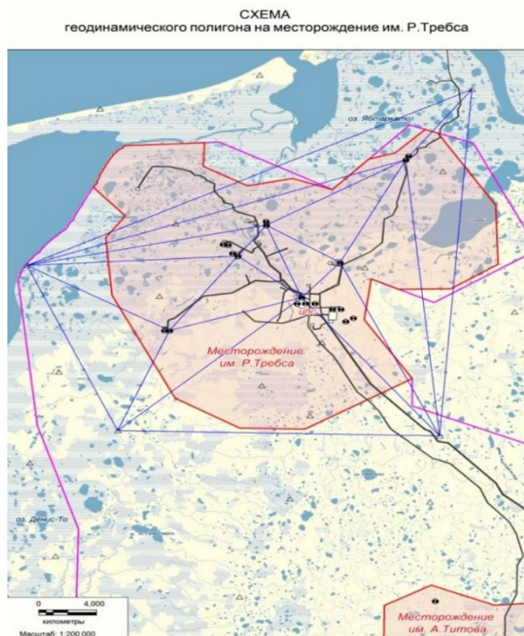
Рис.8. Пример геодинамического полигона с использованием только ГНСС наблюдений
