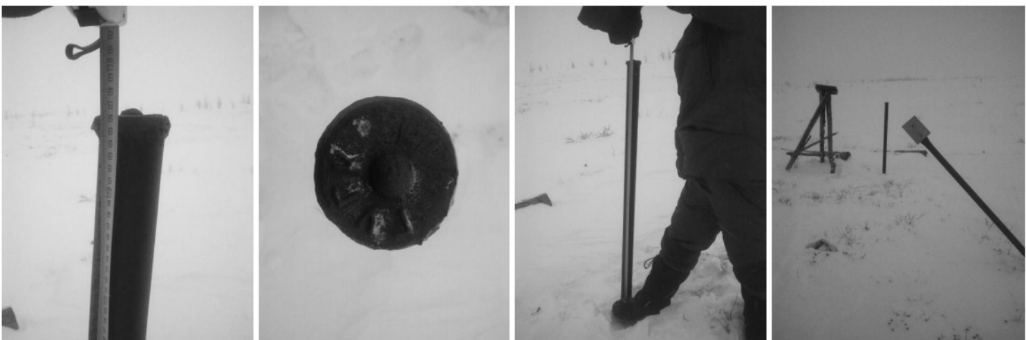
Рис.2. Пункт триангуляции 3 класса, подвергшийся действиям геокриологических процессов
